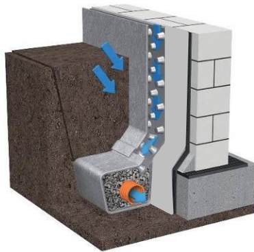
Figure 2: Sens de pose des nappes de protection et drainage DELTA®-MS DRAIN, DELTA®-NP DRAIN et DELTA®-TERRAXX
